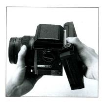
A.カメラからフイルムバックをはずし(GS-Iカメラ使用説明書9頁、「フイルムバックの着脱」の項参照)カメラボデイ上部の取りつけ穴にポラロイドバックGの上部金具をさし、込み、下部をカメラボデイに押しつけます。
