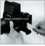
B. 白タブをカメラからまっすぐ、 完全に、一気に引き抜きます。 B. Pull the white tab straight out, until it is completely out of the Polaroid Film Back G, and then discard it.
