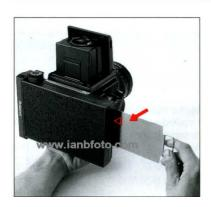
ポラロイドバック G の引蓋には(◇)マークがついています。これは(◇)マークが見える位置まで引蓋を抜けば、完全に抜きとらなくても撮影可能の位置を示しています。
