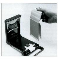
C. フイルムパックから、その一枚を引き抜いたならばこれは捨てます。 裏蓋の開いている間にローラーが汚れていないか点検してください。 C. Draw the yellow tab completely out of the pack film and discard it. While the Polaroid Film Back G is open, check the rollers and see if they are clean.
