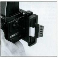
C. 白タブを引き出すと黄タブ引出し口が開いて黄タブが出てきます。白タブを引き出すとき、黄タブ引出し口を指で押えないでください。白タブを引き出しても黄タブが出ないときは、24頁のようにします。つぎタブの出ているときは、白タブを引いてはいけません。
